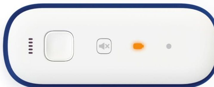
Rysunek 8 Dioda baterii informuje, że baterie nie wystarczą na 24-godzinne badanie
