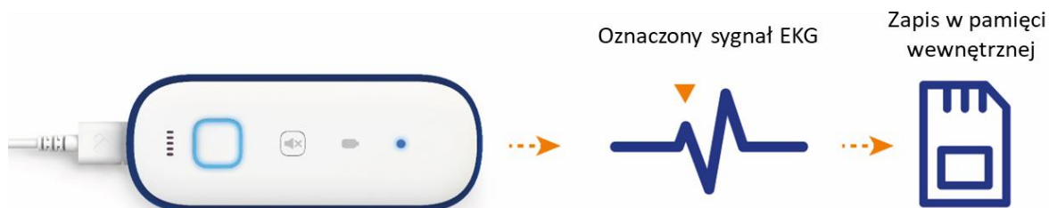
Rysunek 19 Oznaczanie momentu złego samopoczucia na sygnale EKG w trybie long-term
