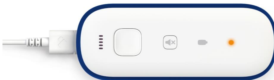
Rysunek 16 Dioda statusu badania informuje o niepoprawnym przebiegu badania
