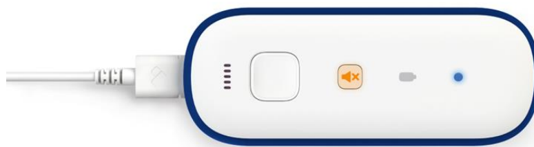
Rysunek 22 Przycisk wyciszenia informujący o wyciszonym urządzeniu
