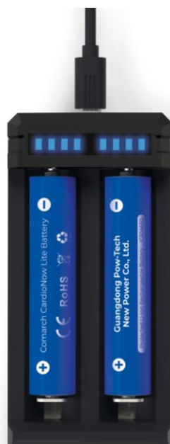
Rysunek 5 Świecenie wszystkich diod na wyświetlaczu wskazujące na pełne naładowanie baterii
