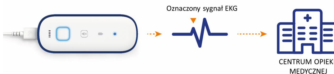
Rysunek 16 Urządzenie informuje o próbie wysłania informacji o zdarzeniu w trybie Tele Holter przy zasięgu sieci komórkowej
