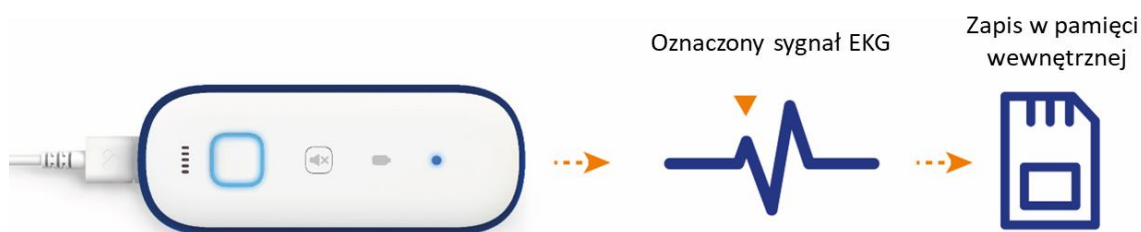
Rysunek 15 Oznaczanie momentu złego samopoczucia na sygnale EKG w trybie Holter
