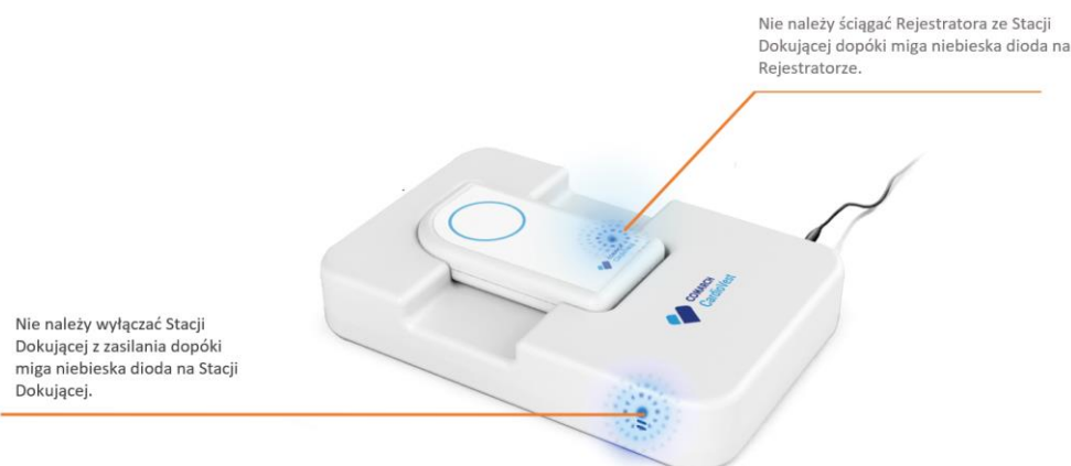
Rysunek 4: Wizualizacja stanu, kiedy diody Rejestratora oraz Stacji Dokującej migają na niebiesko
