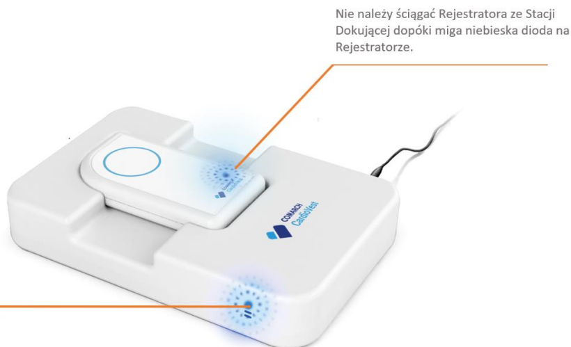
Rysunek 4: Wizualizacja stanu, kiedy diody Rejestratora oraz Stacji Dokującej migają na niebiesko
