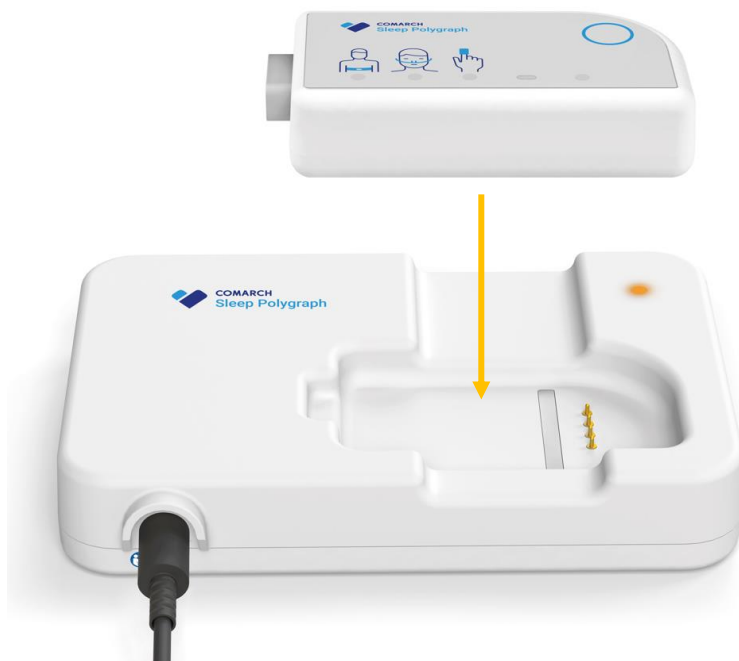
Rysunek 8 Umieszczenie Rejestratora na Stacji Dokującej
