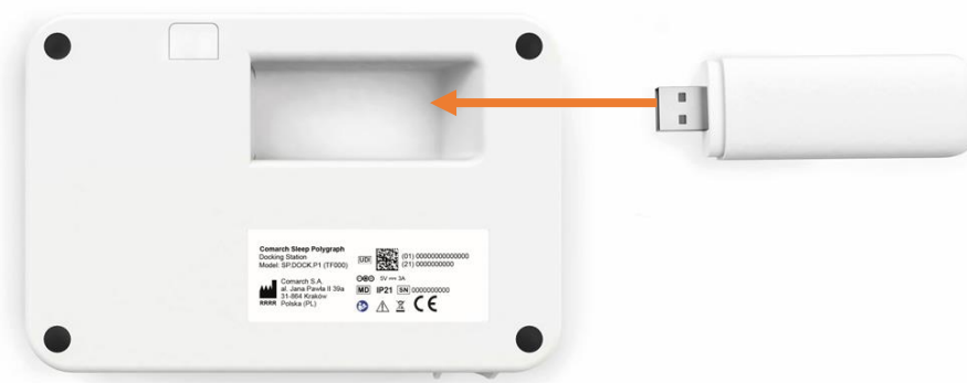
Rysunek 1 Umieszczenie modemu GSM w Stacji Dokującej
