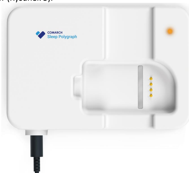
Rysunek 5 Dioda na Stacji Dokującej sygnalizuje, że należy położyć na niej Rejestrator
